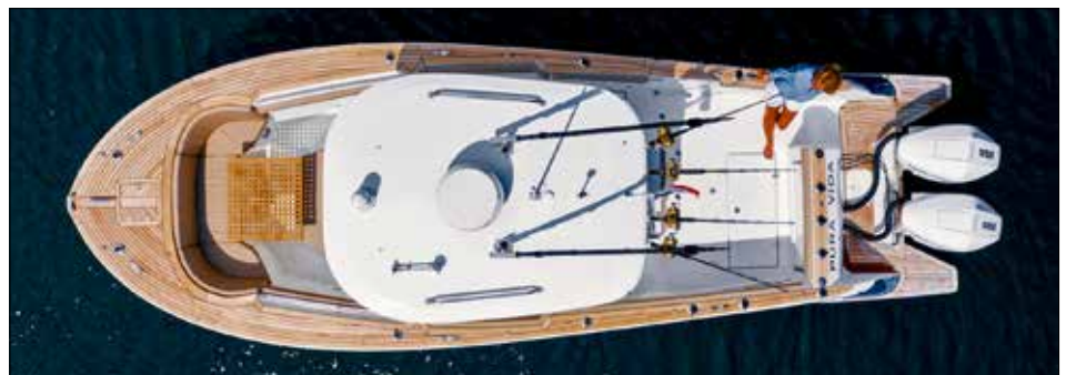
La vue aérienne permet d'apprécier la forme galbée de la coque avec son maître bau très avancé.
